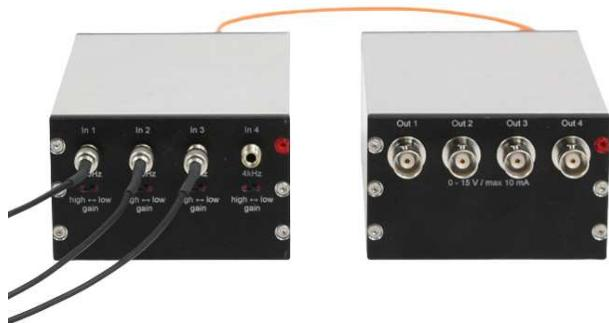
Das System besteht aus zwei batteriebetriebenen Transceivern, die über eine Glasfaser miteinander verbunden sind. Dank der optischen Übertragung und des abgeschirmten Gehäuses eignet sich das System hervorragend für EMV- und EME-Prüfungen gemäß Automobilstandards wie CISPR 25 Klasse 5.
