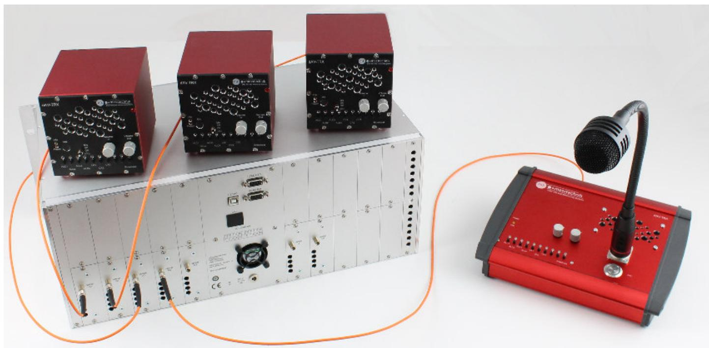
*Beispiel einer Audiomatrix mit drei mobilen Geräten dAV-TRX, einer dAV-TRX Matrix (19"), sowie einem dAV-TRX-Tischgerät (= table top) mit Schwanenhalsmikrofon*
